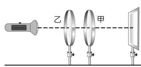
步驟①模擬正常眼睛的成像情形：以凸透鏡甲表示水晶體，屏幕表示視網膜。
