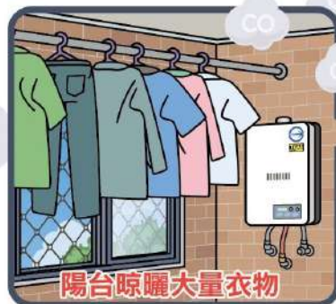
屋外式瓦斯熱水器 安裝在室內
